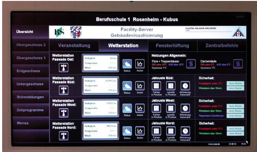
Bild 3: Abgespeichert im Facility-Server stehen die Messwerte praktisch überall zur Verfügung
